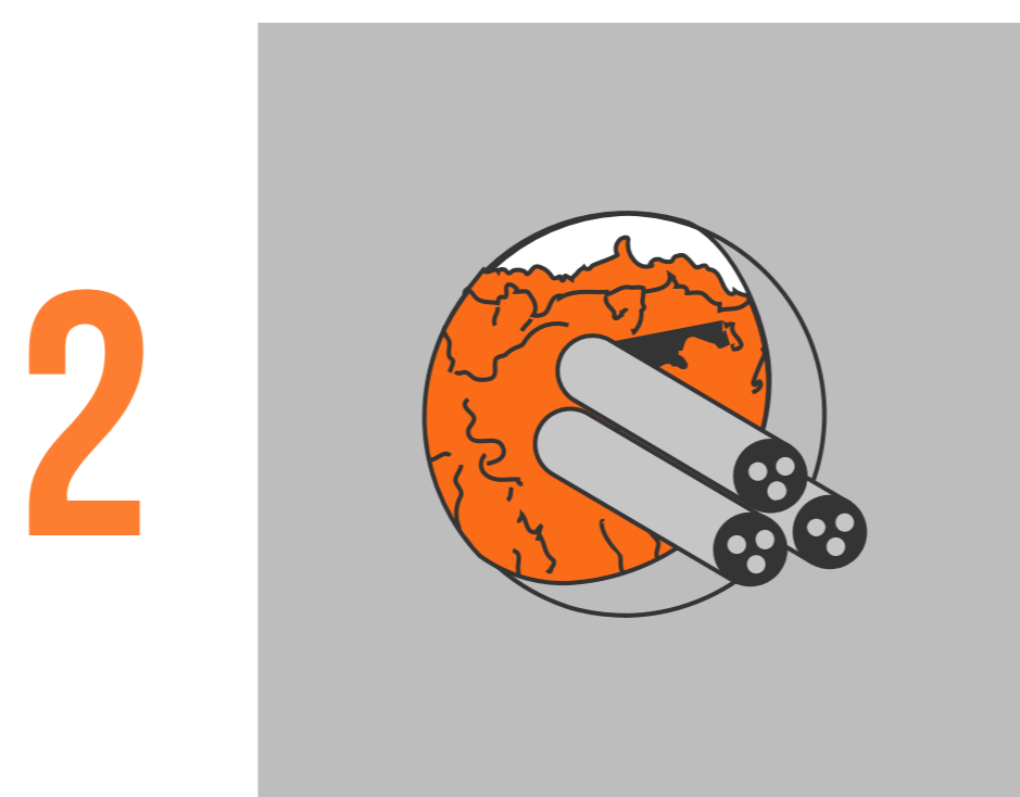
Установите минеральную вату
