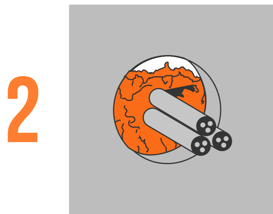
2 Установите минеральную вату
