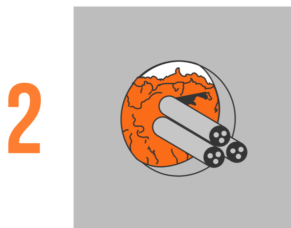
2 Установите минеральную вату
